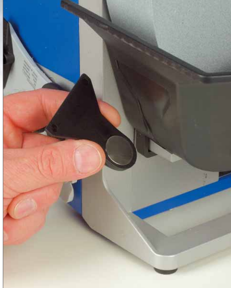
Der magnetische Schaber bindet die Metallpartikel an der Innenseite des Beckens
