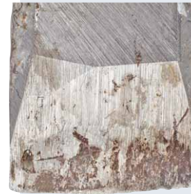
Diese Stechbeitel wurden an gewöhnlichen, schnell drehenden Schleifböcken geschärft. Auch solche im Grunde zerstörte Klingen können mit der T8 schnell wieder instand gesetzt werden
