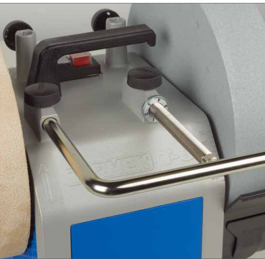
Auf diesem Gestänge werden die verschiedenen Schleifführungen befestigt. Der Abstand und der Winkel des Werkzeuges zum Stein werden durch die Justierschraube eingestellt
